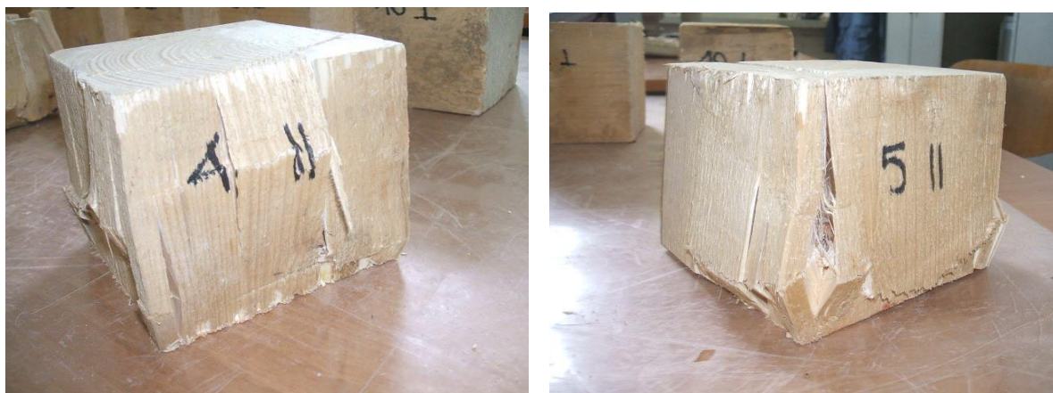
Fig. 112: Specimene de lemn după încercarea la compresiune paralel cu fibra
