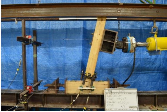
Fig. 85: Setup-ul încercării de încovoiere pe îmbinarea prin chertare
