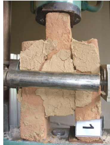
Fig. 121: Specimen realizat din elemente pe bază de pământ stabilizat și mortar din lut
