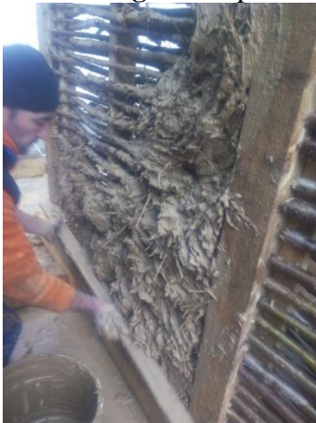
Fig. 145: Specimenul de tip 2 (S3) în timpul construcției – aplicarea pământului amestecat cu paie
