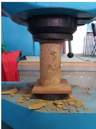
Fig. 109: Compresiune pe cilindri de mortar de pământ (UTCB)
