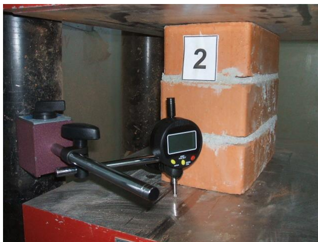
Fig. 107: Specimen de zidărie pentru determinarea la compresiune
