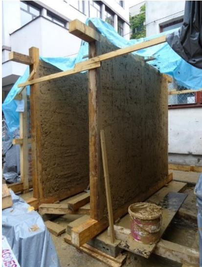
Fig. 146: Specimenul de tip 2 (S3) în timpul construcției – după aplicarea pământului amestecat cu paie
