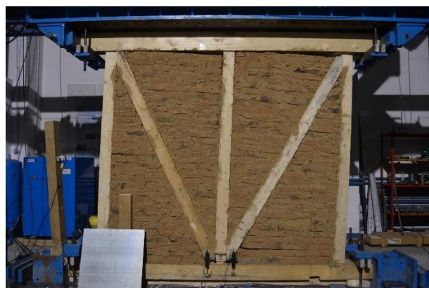
Fig. 158: S2 după încercare, la 4.8 % deformație
