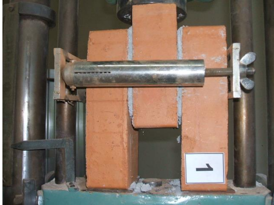
Fig. 120: Specimen realizat din elemente ceramice și mortar de uz general
