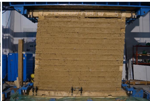
Fig. 162: S4 în ultimul ciclu de încărcare, la 4.5 % deformație unghiulară
