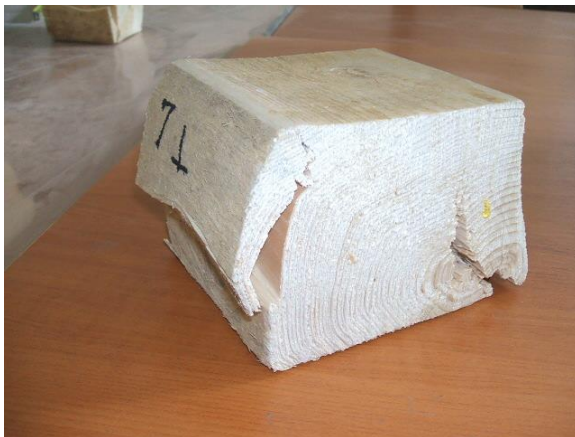
Fig. 114: Specimene de lemn după încercarea la compresiune perpendicular cu fibra
