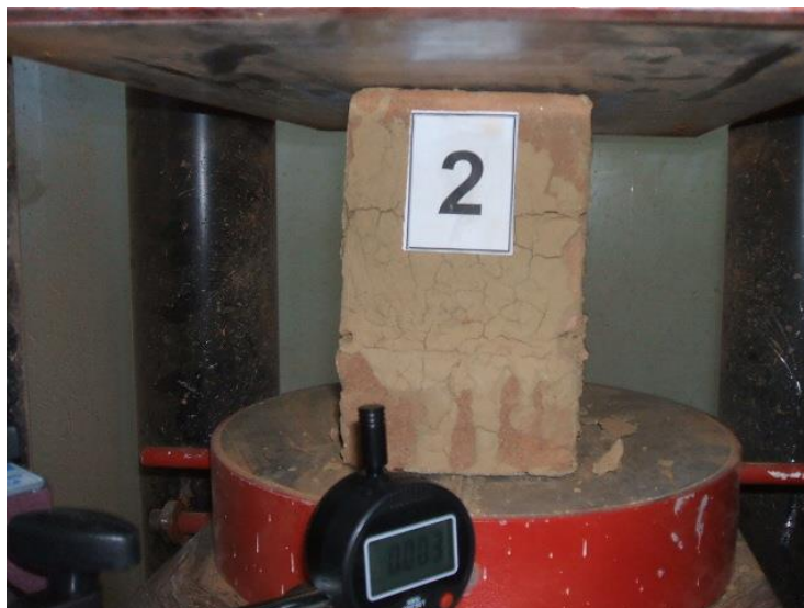
Fig. 105: Specimen de zidărie pentru determinarea la compresiune elemente din pământ stabilizat și mortar din lut
