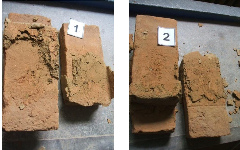
Fig. 123: Specimen realizat din elemente din pământ stabilizat și mortar pe bază de lut – aderența la suport
