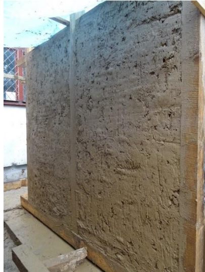
Fig. 146: Specimenul de tip 2 (S3) în timpul construcției – după aplicarea pământului amestecat cu paie
