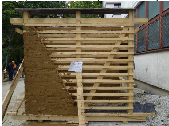
Fig. 147: Specimenul de tip 3 (S4) în timpul construcției – amestecarea pământului cu paie
