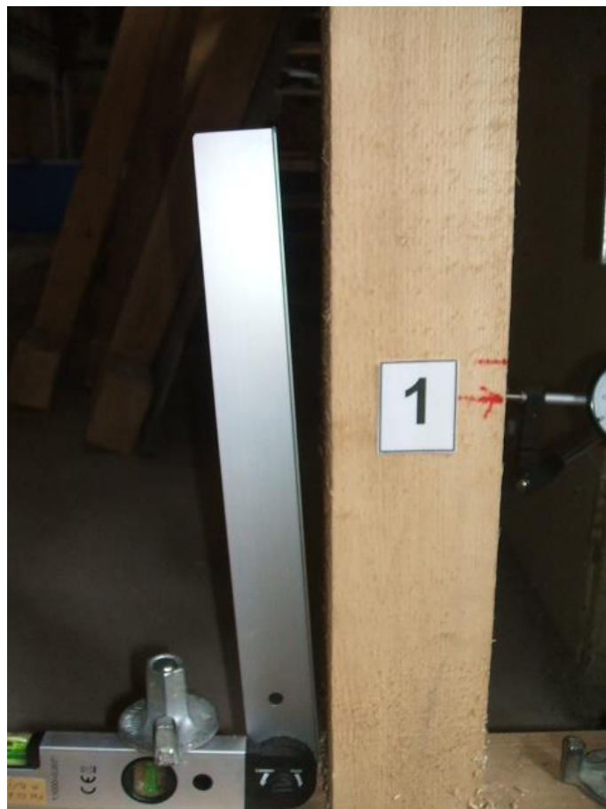
Fig. 131: Revenire elastică în îmbinare
