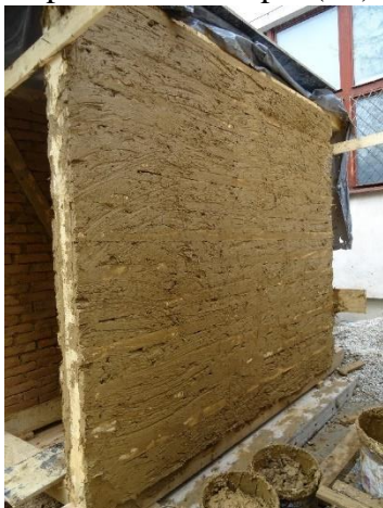
Fig. 148: Specimenul de tip 3 (S4) în timpul construcției – aplicarea pământului cu paie
