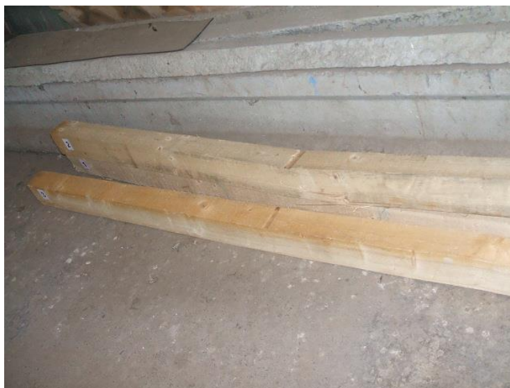
Fig. 117: Specimene de lemn după încercarea la încovoiere
