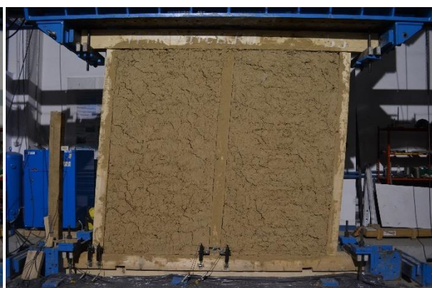
Fig. 160: S3 în ultimul ciclu de încercare, la 6,1 % deformație unghiulară
