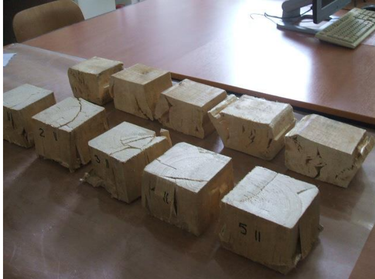
Fig. 115: Specimen de lemn – tipuri de rupere la compresiune
