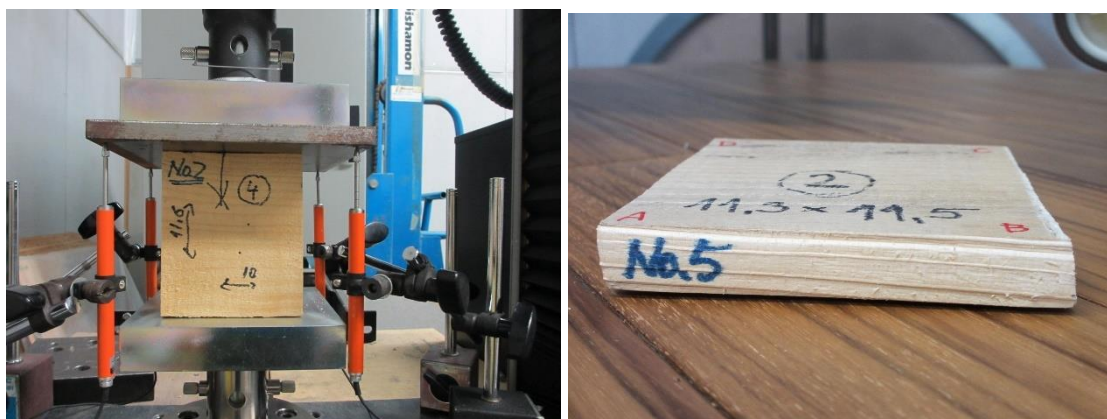
Fig. 110: Compresiune perpendiculară pe direcția fibrei pe cuburi din lemn (stânga) și pe probe rectangulare (dreapta) (BL-Insitute)
