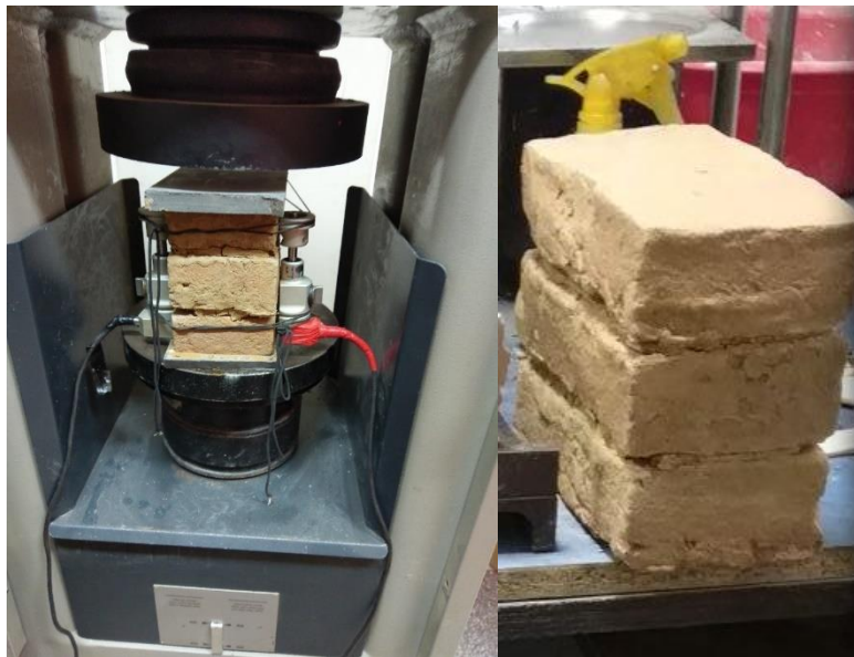
Fig. 103: Încercări la compresiune pe prisme din zidărie de lut
