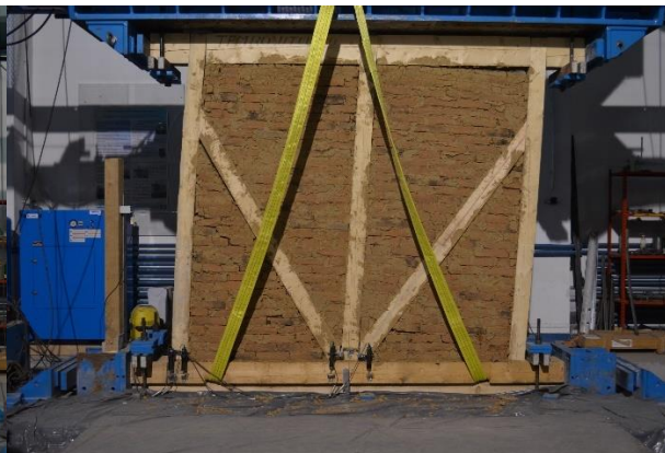
Fig. 156: S1 în ultimul ciclu de încercare, la 5.1 % deformație unghiulară
