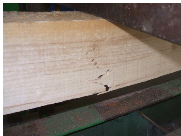
Fig. 119: Specimen de lemn – tipuri de rupere la încovoiere
