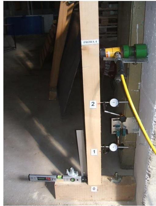
Fig. 125: Schema de testare la solicitări ciclice a îmbinărilor din lemn
