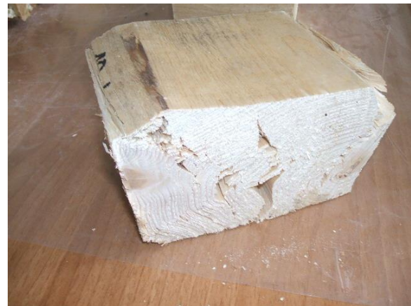
Fig. 114: Specimene de lemn după încercarea la compresiune perpendicular cu fibra
