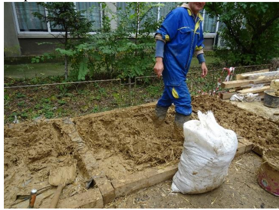
Fig. 147: Specimenul de tip 3 (S4) în timpul construcției – amestecarea pământului cu paie
