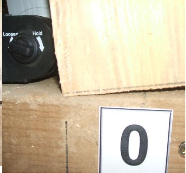
Fig. 130: Rotire în îmbinare – prindere în holşuruburi
